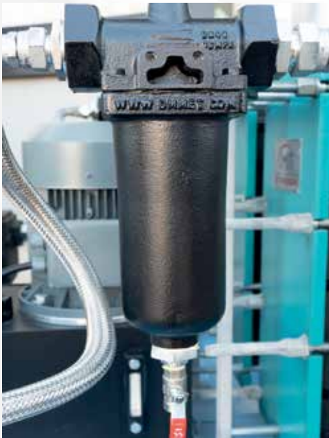
DOSING UNIT EDGE FILTER
